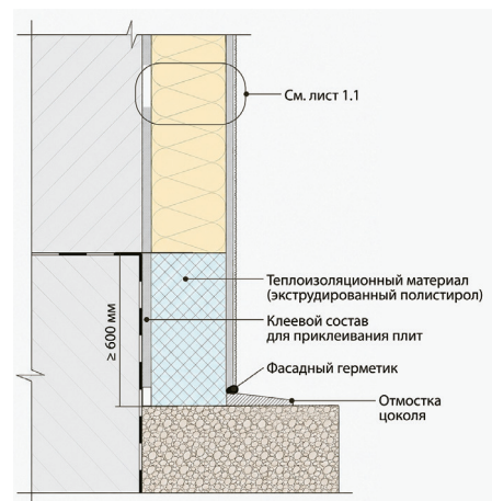
Рис. 19. Примыкание фасадного утеплителя заподлицо к утепляемому цоколю. Стрелками показан экструдированный пенополистирол
