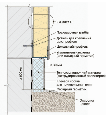
Рис. 16. Узел примыкания фасадной теплоизоляции к утепляемому цоколю.
