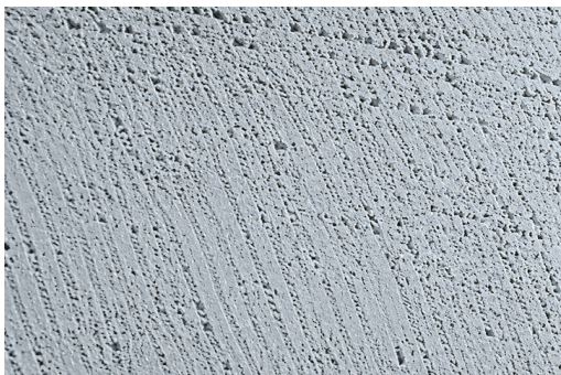
Рис. 20. Гладкую и ламинированную поверхность экструдированного пенополистирола необходимо сделать шершавой.
